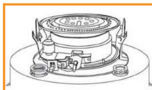
7. Quite las cuatro tuercas de mariposa que mantiene el montaje de la mecha junto a la estufa y cuidadosamente levante el montaje de la mecha.
