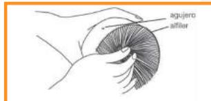
12. Apriete la mecha nueva en los dientes del retenedor de la funda de la mecha para que la mecha se adhiera herméticamente en el interior de la funda de la mecha para que no está suelta en cualquier parte.
