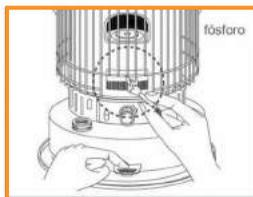
NOTA Asegúrese de no dejar el fósforo, o cualquier parte de él (cabeza del fósforo, etc.) en el área del quemador. Restos del fósforo pueden causar una alineación desigual del quemador y pueden producir humo, combustión incompleta, olor o fuego.
