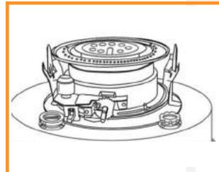
21.Pruebe el encendido. Suba la mecha a su altura máxima. El filamento del encendido debe estar entre 1mm y 2mm de la mecha cuando se activa el encendido.
