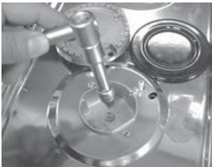
Para adaptarla al uso con otro tipo de gas, (Natural o Manufacturado), se deben realizar algunas modificaciones en sus quemadores y grifos, las cuales consisten en cambio de inyektors, regulación de aire primario y consumo en mínimo.
